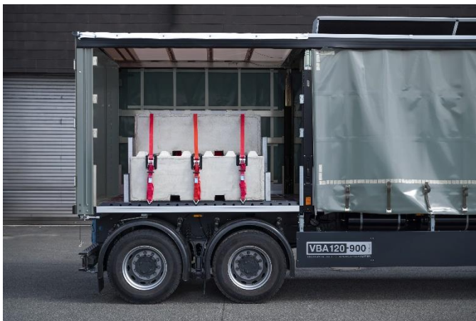
Ballastierung mit Betongewichten
